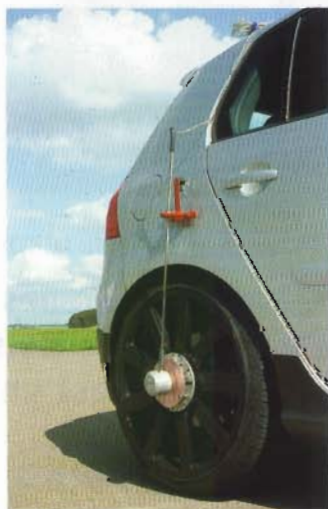
Bewährte Messtechnik. Der Radnabenaufnehmer misst mit hoher Genauigkeit
