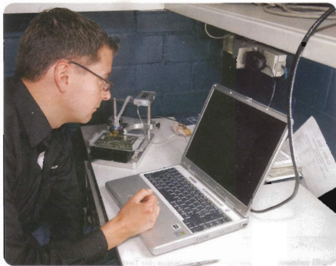
Denkzentrale: Zur Neuprogrammierung wird das Steuergerät geöffnet. Das Chip-Tuning ist für die Motordiagnosegeräte der Fahrzeughersteller unsichtbar.
