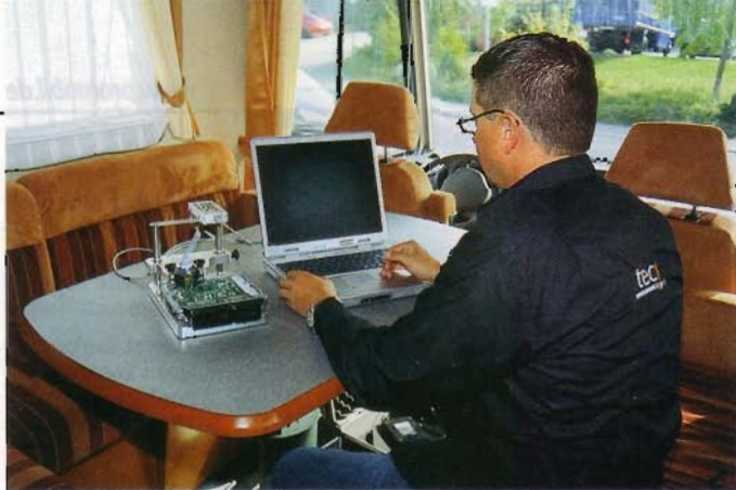
Die Motorsteuerung wird mit einem Spezialgerät umprogrammiert.
