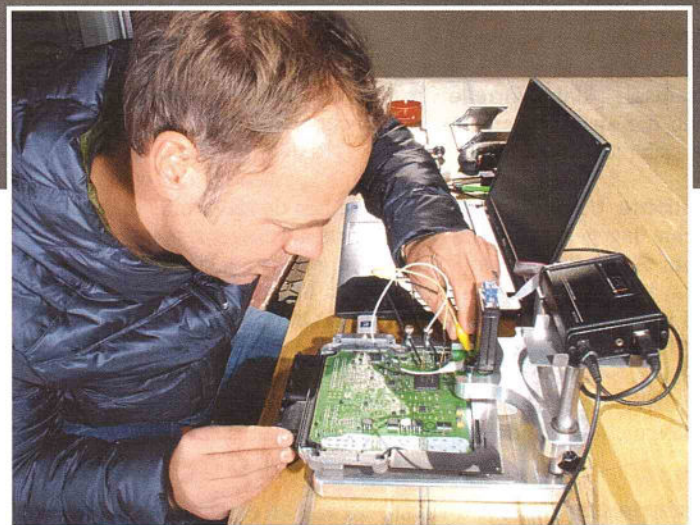
Operation am offenen Herzen. Über ein spezielles Interface wird der geänderte Datensatz auf den Chip des Serienmotorsteuergeräts aufgespielt.
