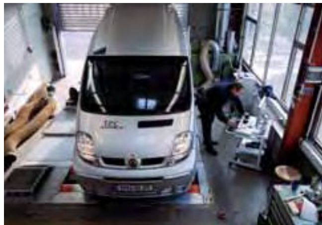
■ Der Renault kommt zur Kontrolle wieder auf den Rollenprüfstand.
