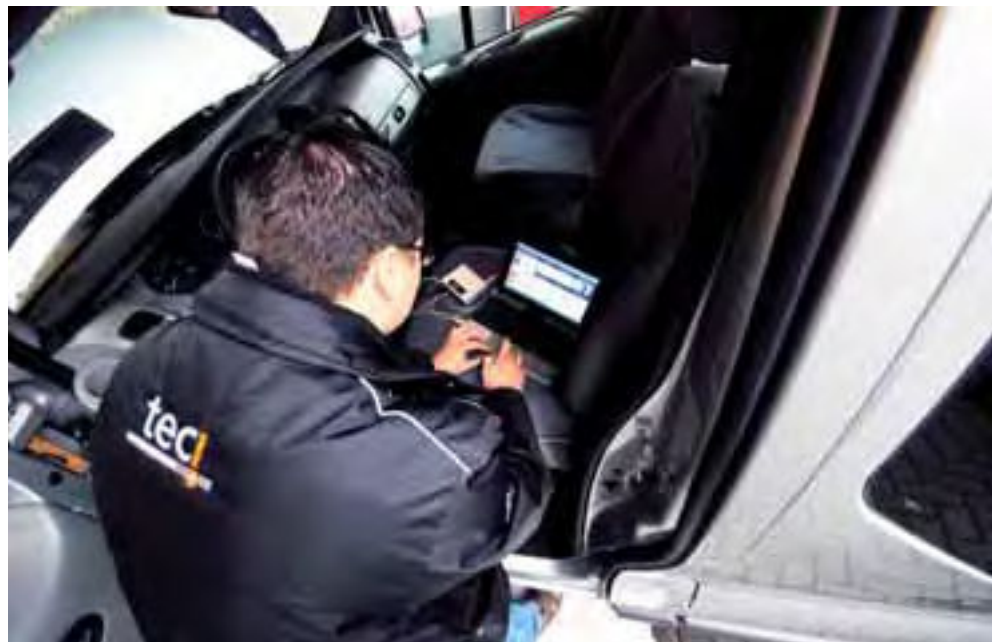
■ Die geänderten Daten werden wieder in das Steuergerät übertragen.
