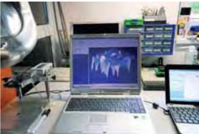
■ Chip-Tuning ist Eingriff und Veränderung der Kennfelder des Steuergerätes. Hier ein Kennfeld nach dem Tuning.
