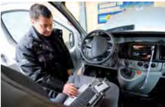
■ Die Daten werden über die Diagnose-Schnittstelle aus dem Steuergerät gelesen.
