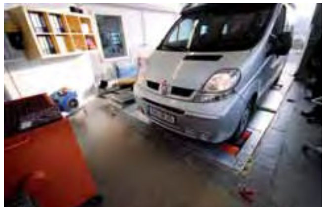
■ Vor dem Tuning: Die Originalwerte werden am Prüfstand gecheckt und dokumentiert.
